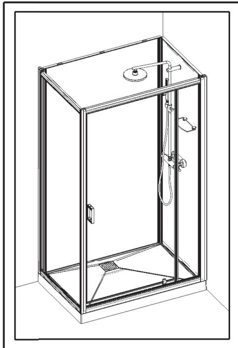
● Vous avez la possibilité de réaliser un montage à droite ou un montage à gauche. Notre notice d'installation décrit un montage à gauche. Si vous voulez réaliser un montage à droite, il vous suffit d'inverser le montage.
