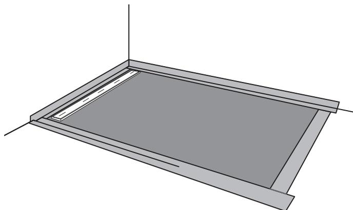
10) L'écoulement linéaire est réglable en hauteur et pour s'adapter à différentes épaisseurs de carrelages (6–21 mm). Pour ajuster la hauteur, tourner les vis rouges à l'aide d'un tournevis plat.
