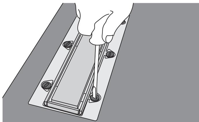
11) La grille amovible en inox peut être carrelée au verso. Il suffit de la tourner puis de la carrelé.
