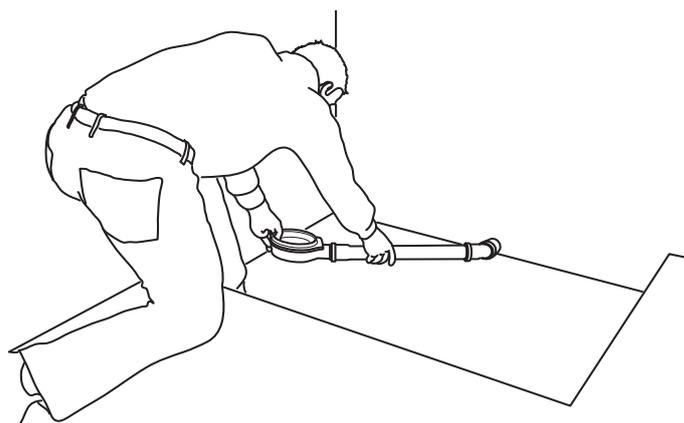
3) Comblers la réservation avec un mortier de remplissage et rasers au niveau du siphon de façon à obtenir une surface lisse et horizontale. L'écart en hauteur par rapport à la chape résulte de l'épaisseur du receveur (60, 70 ou 80 mm) + env. 5 mm mortier-colle. Le siphon doit être scellé dans le mortier pour pouvoir supporter les charges.
