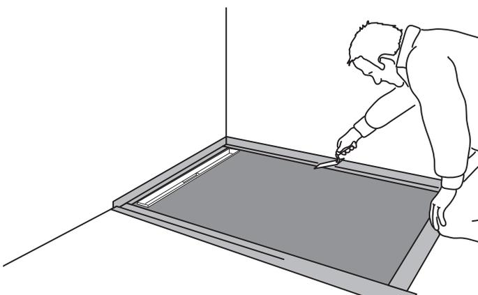
8) Etanchéfier soigneusement toutes les jonctions en utilisant la bande d'étanchéité JACKOBOARD® et du mortier-colle.
