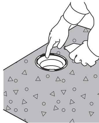
6) Encoller entièrement la sous-face du receveur avec un mortier-colle.
