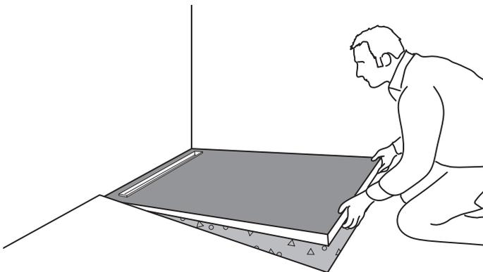
7) Positionner JACKOBOARD® Aqua Line pro dans la réservation de sorte que le raccordement de l'écoulement linéaire s'insère dans la bague d'étanchéité du siphon.
