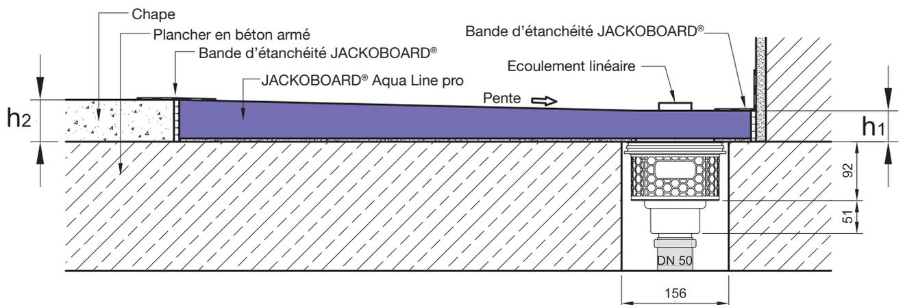
h<sub>1</sub> = 48 mm = Épaisseur du receveur (43 mm) + 5 mm mortier-colle (épaisseur minimale requise côté écoulement linéaire)
