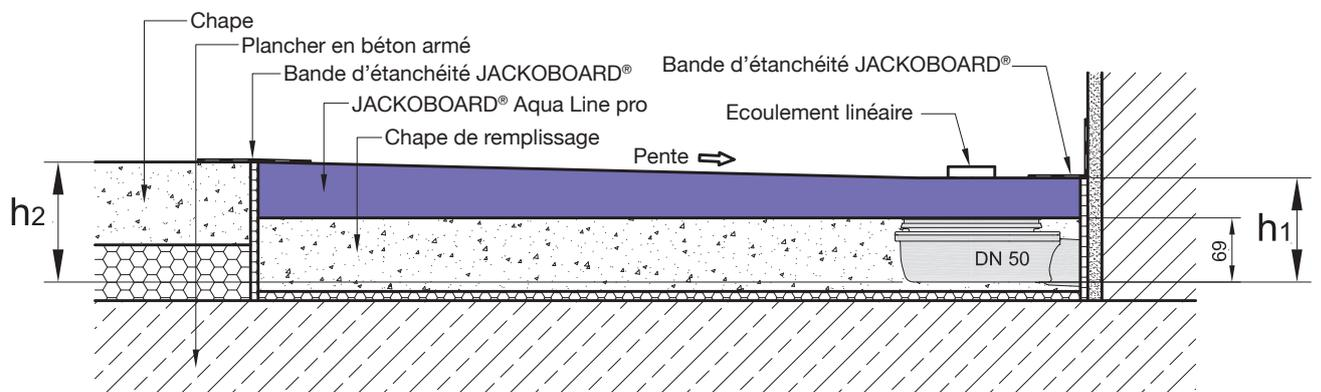
h<sub>1</sub> = 114 mm (épaisseur minimale requise côté écoulement linéaire)
